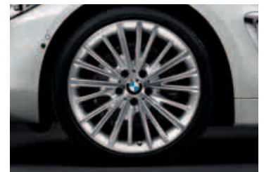
19" Leichtmetallräder Vielspeiche 399 mit Mischbereifung 8Jx19 mit Bereifung 225/40 vorn 8½Jx19 mit Bereifung 255/35 hinten
