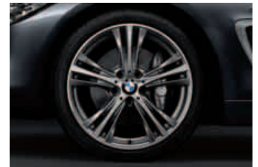
19" Leichtmetallräder Sternspeiche 407 mit Mischbereifung 8Jx19 mit Bereifung 225/40 vorn 8½Jx19 mit Bereifung 255/35 hinten
