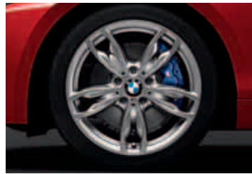
M Sportbremse, Festsattelbremse in dunkelblau lackiert mit M Schriftzug, vorn und hinten
