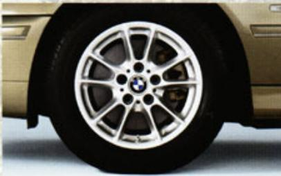
Das Leichtmetallrad Radialspeiche 50 ist in der Größe 7 J x 16 Zoll mit der Bereifung 225/55 R 16 ausgeführt.
