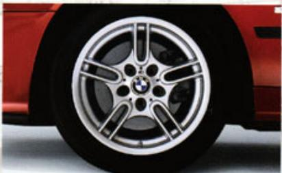
Das Leichtmetallrad M Parallelspeiche 66 ist in der Größe 8 J x 17 Zoll mit der Bereifung 235/45 R 17 ausgeführt.
