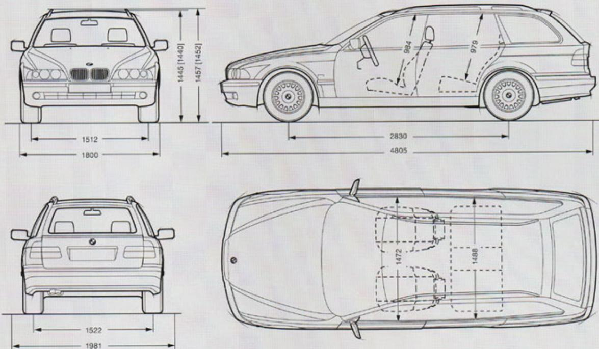
Alle Maßangaben der technischen Zeichnungen in Millimeter. Werte in [ ] gelten für 530i und 540i. Gepäckraumvolumen 410–1525 Liter (VDA-Messung).
