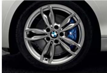
M Sportbremse, Festsattelbremse in dunkelblau lackiert mit M Schriftzug, vorn und hinten
