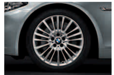
19" Leichtmetallräder Vielspeiche 455 mit Mischbereifung 8½Jx19 mit Bereifung 245/40 vorn 9Jx19 mit Bereifung 275/35 hinten
