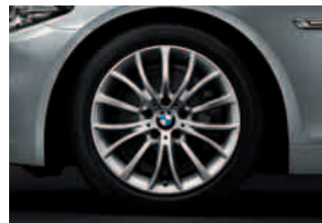
18" Leichtmetallräder Vielspeiche 454 8Jx18 mit Bereifung 245/45
